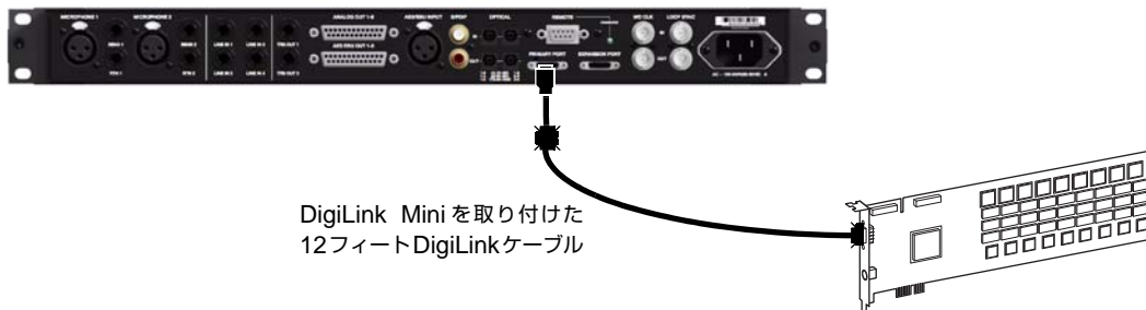
図 5. Pro Tools|HD Accel Coreカードの [DigiLink Port] へ接続したHD OMNI（8チャンネルのシステム）
